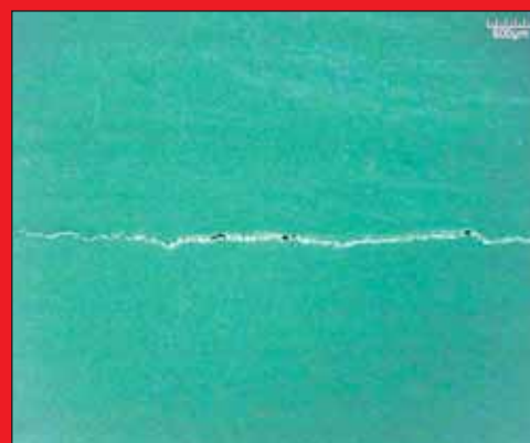
Detail mikrotrhlíny v krycom ochrannom nátere dreveného okna pred (vľavo) a po (vpravo) ošetrovaní súpravou na údržbu okien.
